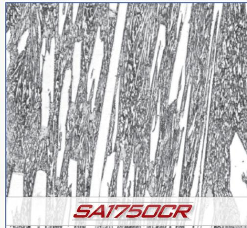
A modo de comparación, lo anterior es la microestructura de la placa de revestimiento de carburo de cromo SA1750CR. Puede ver los carburos mucho más grandes dentro de la microestructura. Estos carburos grandes reducen la resistencia al impacto del material.
